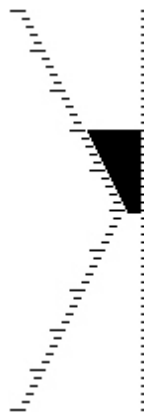
Rys.3.2 – Analogowy wskaźnik wariometru
